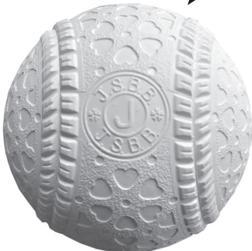
2019年から学童野球で公式採用される新規格のボール。規格は中学生以上が使用するM号（すでに2018年から販売され各大会でも使用されている）と学童が使用するJ号の2つ。ハート型のディンプル加工が特徴的で六代目よりも直径（69 ± 0.5mm）はアップサイジング、重量（129 ± 1.8g）は増加した
